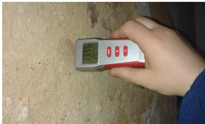
obr. /4/ Zvýšená vlhkost suterénního zdiva
